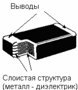
Рис. 5.3. Конструкция чип-конденсатора для поверхностного монтажа.
