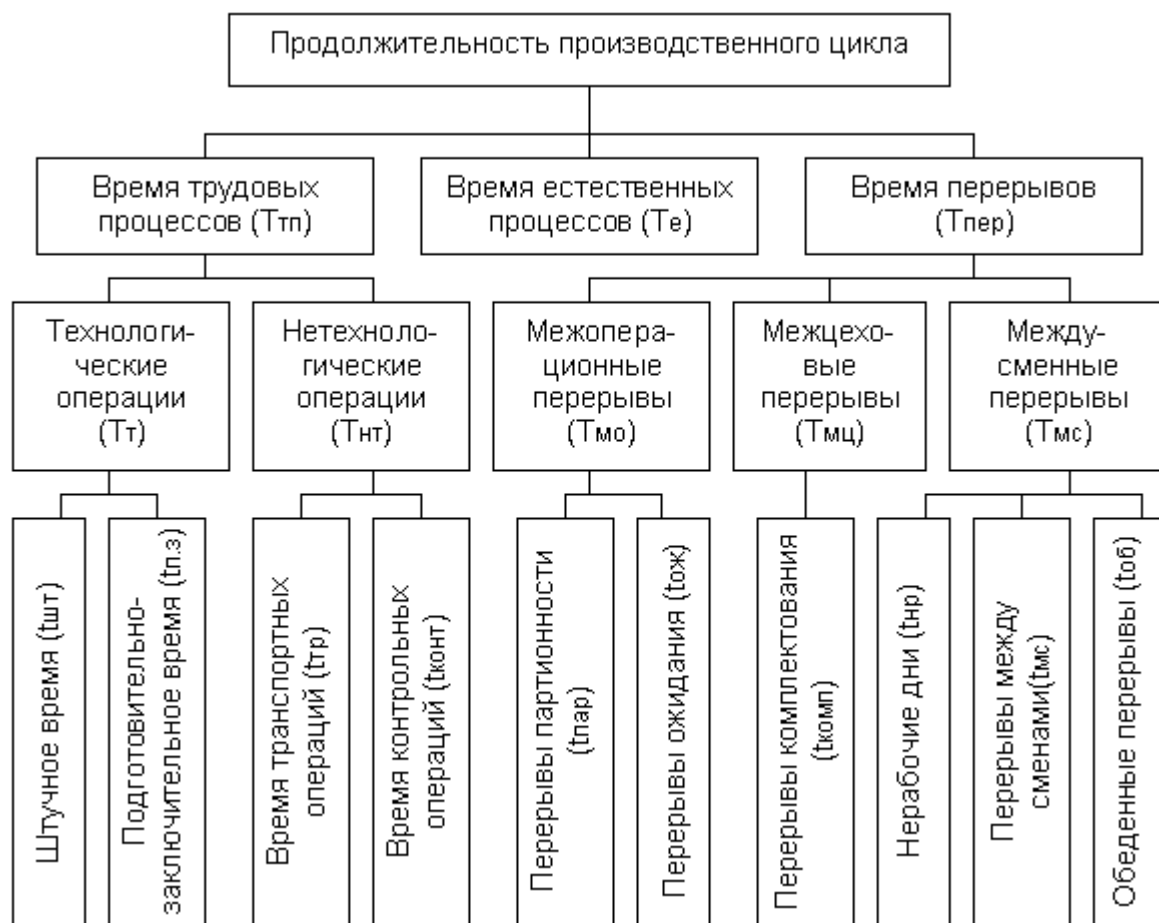
Рис. 13.2. Структура производственного цикла.
