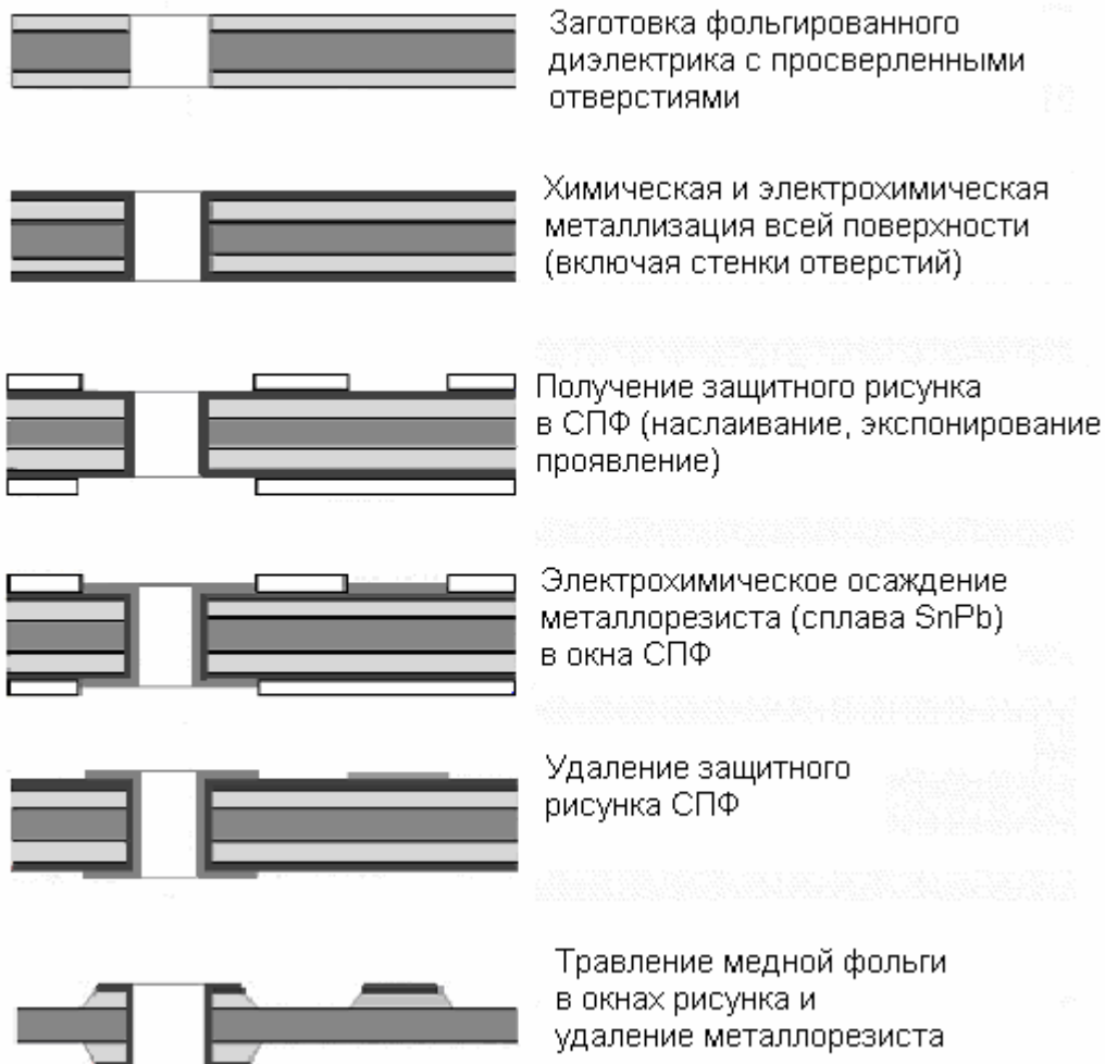
Рис. 6.3. Субтрактивный метод: позитивный процесс с использованием СПФ и металлорезиста (сплава SnPb ).
