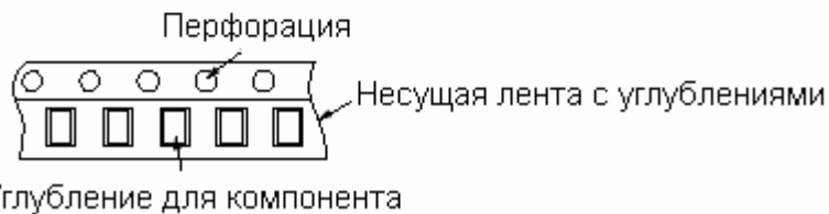
Рис. 5.4. Способ упаковки компонентов для подачи на сборку.
