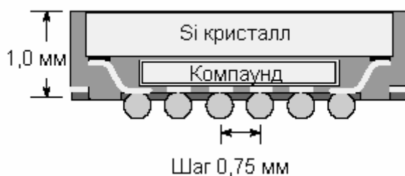
Рис. 5.11. Структура корпуса ИМ типа CSP.
